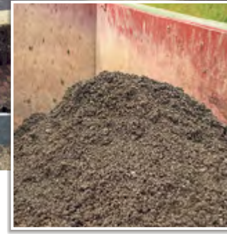
Der ausgesprester Schlamm wird in Container gefüllt.
