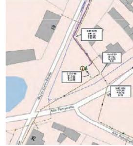
wassernetz. Um bei Bauarbeiten Schaden zu vermeiden, verschaffen wir Bauherren einen Überblick über die vorhandenen Leitungsdaten im Plangebiet. Dazu gehören vorrangig die Leitungsort, ihr Durchmesser, ihre Tiefenlage, falls wir die kennen, sowie Besonderheiten wie Steuerkabel für Pumpwerke oder dergleichen. Leider sind die genaue Lage und Verlegetiefe von älteren Leitungen nicht immer bekannt. Auch über Entwässerungsanlagen auf Privatgrundstücken hat der Verband keine Kenntnisse.“ Mit Hilfe der
